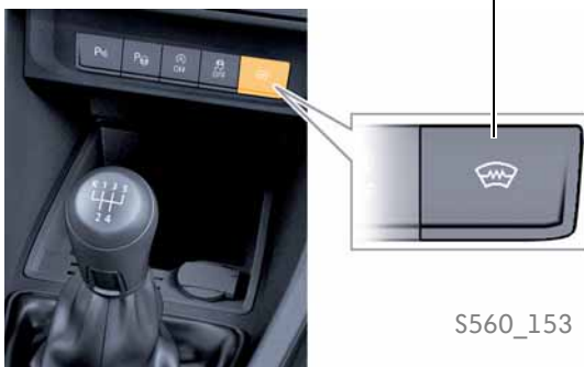
Schalter für beheizbare Frontscheibe E180 in der Schalterleiste der Mittelkonsole
