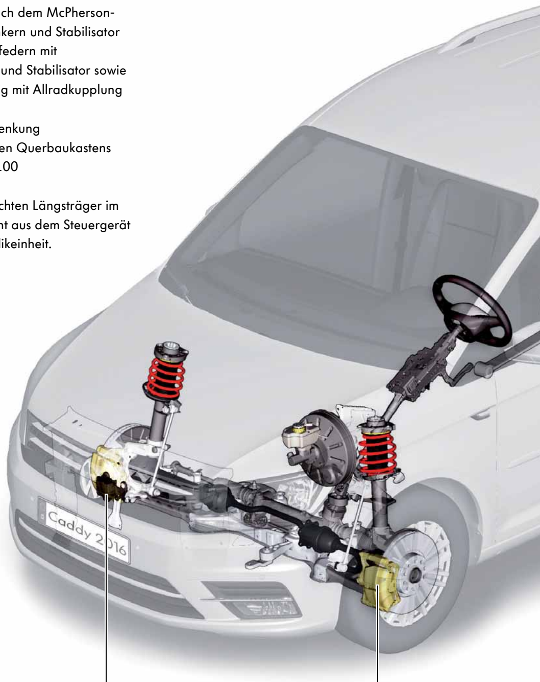
hinter dem Volkswagen Emblem: Steuergerät für Abstandsregelung J428
