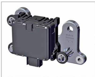
Steuergerät für Abstandsregelung J428
