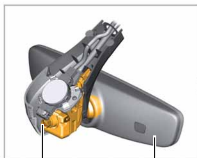
Frontkamera für Fahrerassistenzsysteme R242
