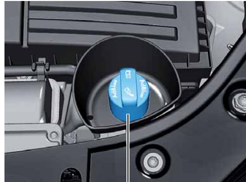
Einfüllstutzen für Reduktionsmittel
