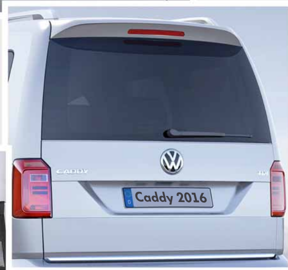
Heckklappe mit größerem Kennzeichenfeld und durchgehender Heckscheibe
