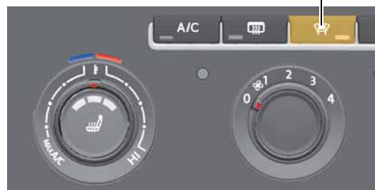
Schalter für beheizbare Frontscheibe E180 in der Bedieneinheit der Klimaanlage
